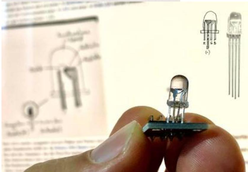
6. Rote Leuchtdioden werden ausgeteilt und pro Plakat und Person eine dieser roten LEDs an die zuletzt freigelegten Drähte gelötet. Der Plus-Pol wird am Kabelende markiert.
