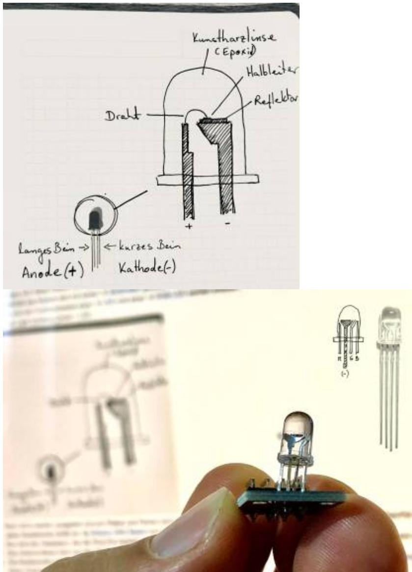
6. Rote Leuchtdioden werden ausgeteilt und pro Plakat und Person eine dieser roten LEDs an die zuletzt freigelegten Drähte gelötet. Der Plus-Pol (Anode der LED) wird am Kabelende markiert.
